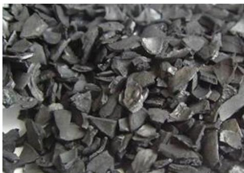
Gambar 4. Arang cangkang kelapa sawit
