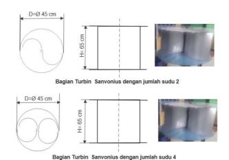
Gambar 1. Turbin angin Savonius tipe U dengan jumlah sudu 2 dan 4
