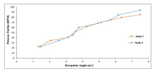
Gambar 3. Hubungan kecapatan angin dan putaran poros turbin Savonius dengan sudu 2 dan 4
