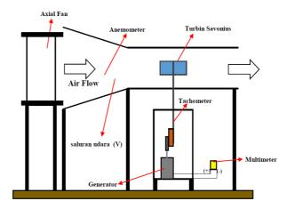
Gambar 2. Skematik pengujian dan penempatan alat ukur
