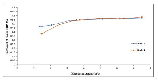
Gambar 4. Hubungan COP dan kecepatan angin turbin
