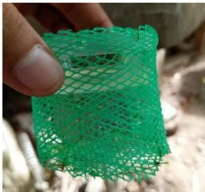
Gambar 4. Saringan pada alat pemanen madu pompa elektrik
