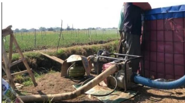
Gambar 4. Mesin *diesel* yang digunakan untuk memompa air dari tandon air
